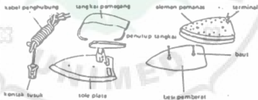
Gambar 2-3. Bagian-bagian seterika listrik
