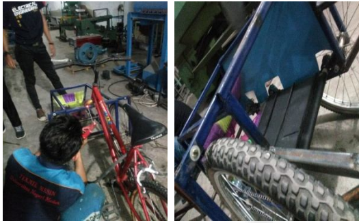
Gambar 11. Proses menyatukan sepeda dan rangka depan penyapu
