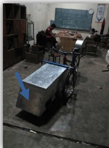
Gambar 6. Bagian depan yang merupakan alat penyapu sampah
