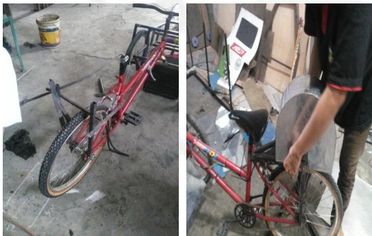
Gambar 13. Proses pembuatanudukan dan penutup motor BLDC
