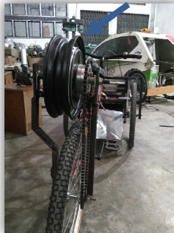
Gambar 5. Motor BLDC Sebagai Penggerak
