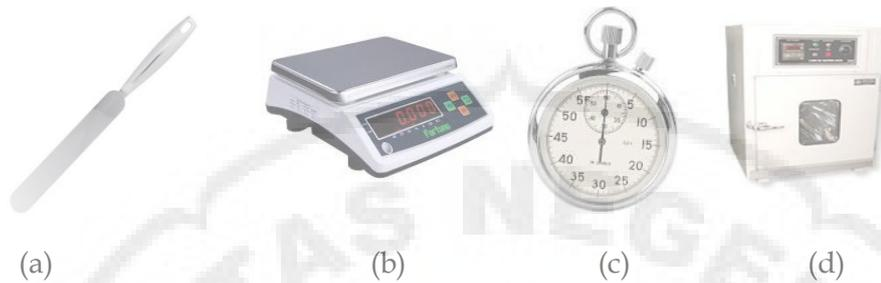
Gambar 1.5 Peralat uji kekuatan geser langsung (a). spatula; (b). timbangan; (c). arloji pengukur waktu (*stopwatch*); dan (d). oven (Sumber : Panduan penuntun mekanika tanah, 2016)
